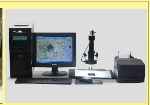
Elektronenmikroskopische Messung des Kerbdurchmessers (Ultimheat Labor)
