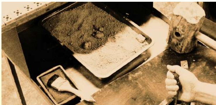
Reihenklemmen aus Porzellan, mit der Hammerpresse hergestellt: Manuelles Abfüllen von Nassgranulat (Privatsammlung) Trocknen von Elektroporzellan nach dem Pressen (Privatsammlung)
