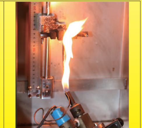
Prüflinge während der Prüfung laut UL94 V-0
